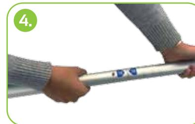
Monte a estrutura encaixando os tubos de alumínio conforme indicado na imagem, seguindo a ordem dos números que se encontram marcados nas duas extremidades dos tubos. Depois da estrutura estar montada coloque o tubo central (se existente).
